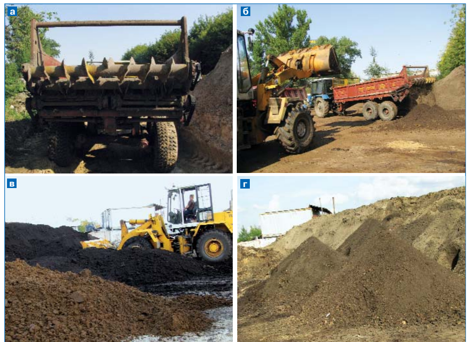
■ Рис. 3. Промышленные испытания изготовления почвогрунтов: шнековый смеситель (а), изготовление почвогрунта с использованием осадка станций водоподготовки (б), изготовление почвогрунта из смеси осадков (в), готовый почвогрунт (г)
