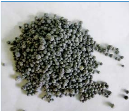
■ Рис. 2. Полученный пеностекло-гранулят из стеклобоя и водопродоводного осадка
